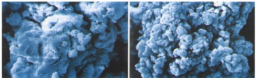
*Photo 7 : Chaux hydratée (à gauche) et Spongiacal®/Captacal® (à droite) (Source : Balthazard & Cotte et Lhoist)*
