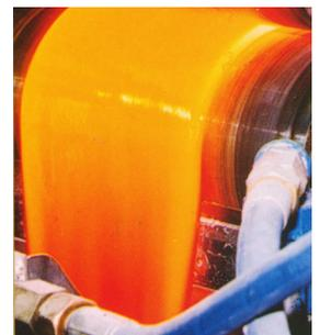
Photo 8 : Coulée de vitrifiat en sortie de four (Source : Europlasma)
